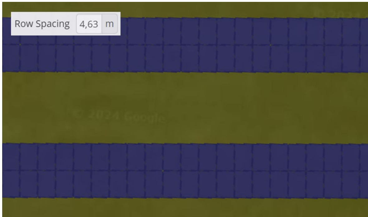
Figura 41: Detalle de la separación de filas de paneles fotovoltaicos [Helioscope]
