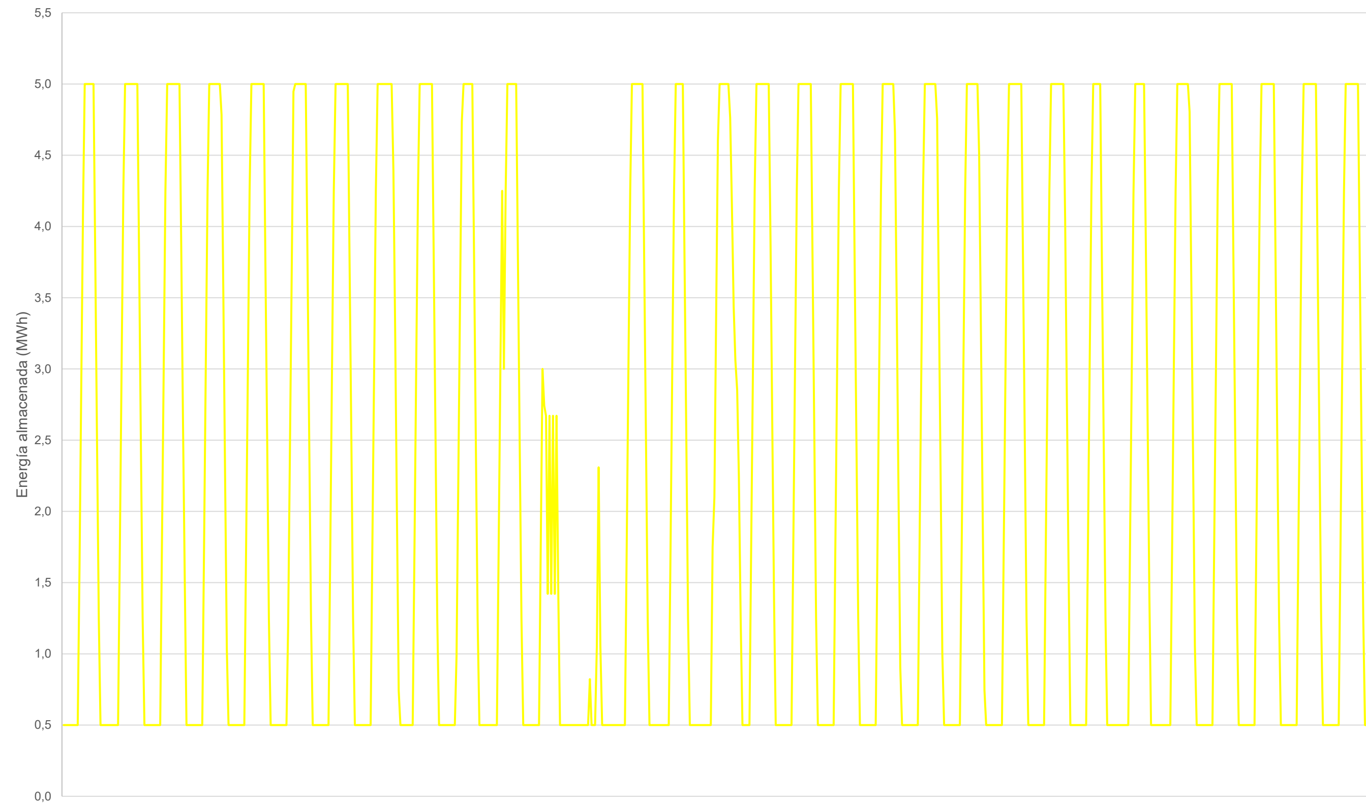
Estado de carga del sistema de almacenamiento de la planta fotovoltaica (Mayo)
