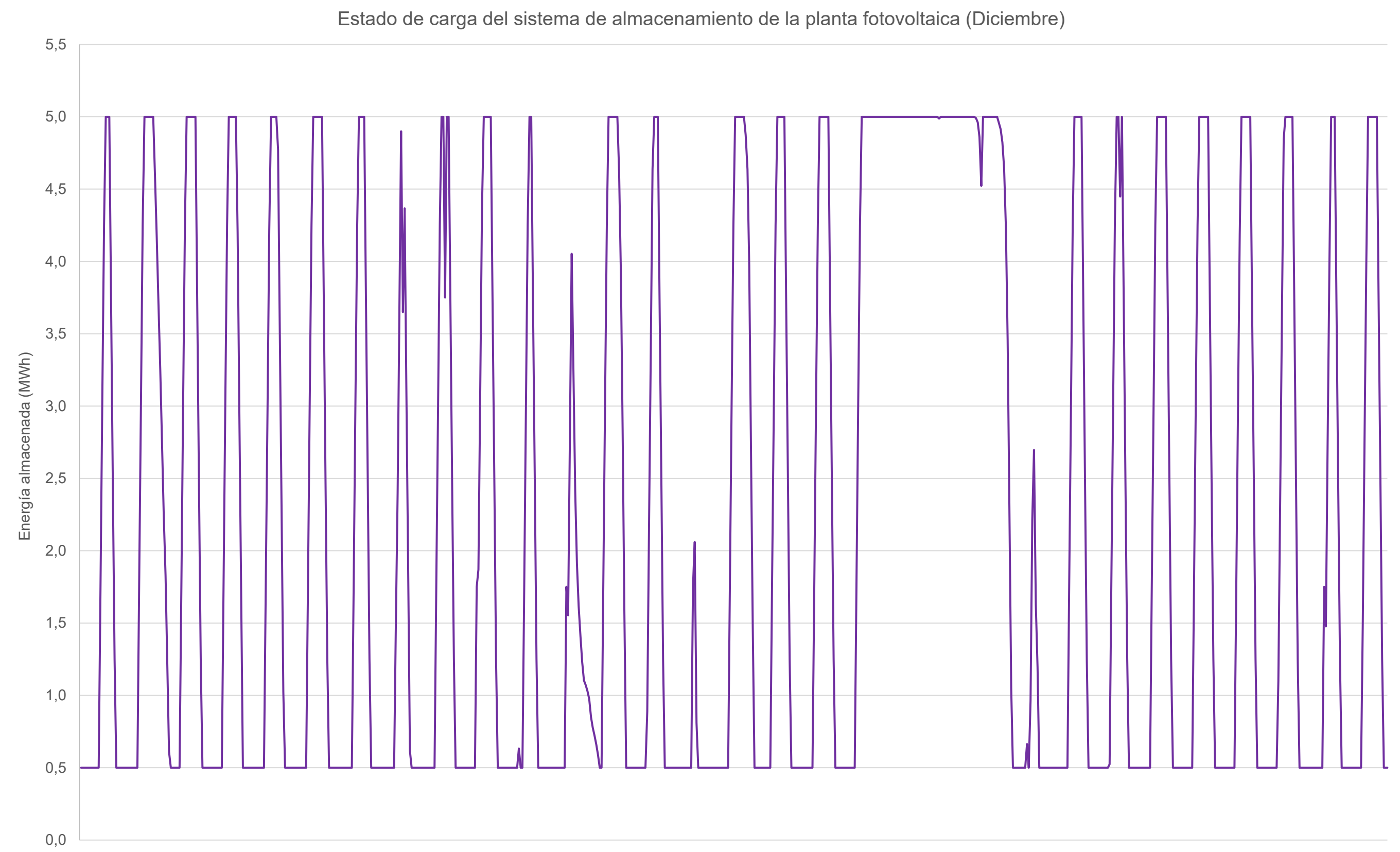
Figura 62: Estado de carga del sistema de almacenamiento de la planta fotovoltaica (Diciembre)
