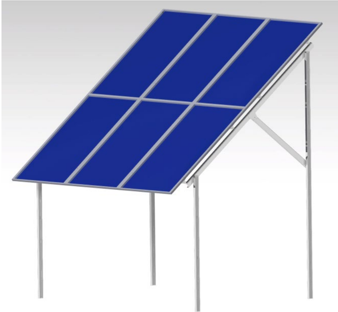
Figura 34: Diseño estructura fija para soporte de paneles fotovoltaicos
